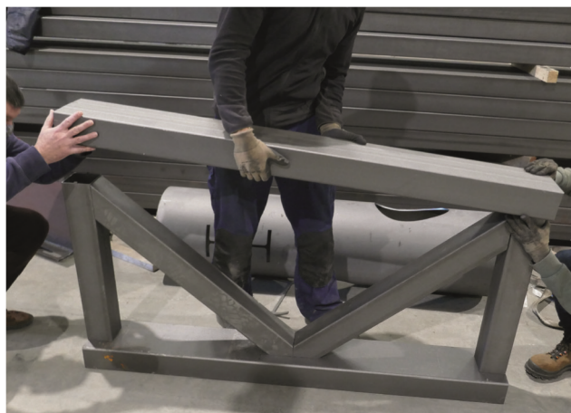
Exemple d'éléments de charpente tubulaire pré-assemblés avant soudage par un système tenons/mortaises.
