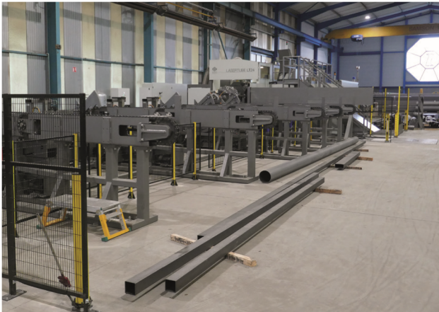
Le nouveau Laser Tube LT24 avec son système de chargement automatique acceptant des longueurs jusqu'à 18 mètres.
